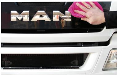
Der Untergrund muss vor dem Klebevorgang absolut sauber (Staub- & Fettfrei) sein. Am besten eignen sich hierfür Pflegeprodukte aus dem Kfz-Bereich. Anschließend entfetten Sie den Untergrund mit einem Entfetter evtl. Isopropanol oder ähnliches Produkt. Wichtig! Der Untergrund darf nicht mit Produkten, die einen Lotuseffekt hervorrufen, behandelt worden sein.
